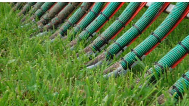
Mit dem Schleppschuhverteiler lässt sich Gülle in die angewachsene Grasnarbe ablegen – das Ausbringenfenster wird größer und günstigere Ausbringbedingungen können abgewartet und Maschinen besser ausgenutzt werden
