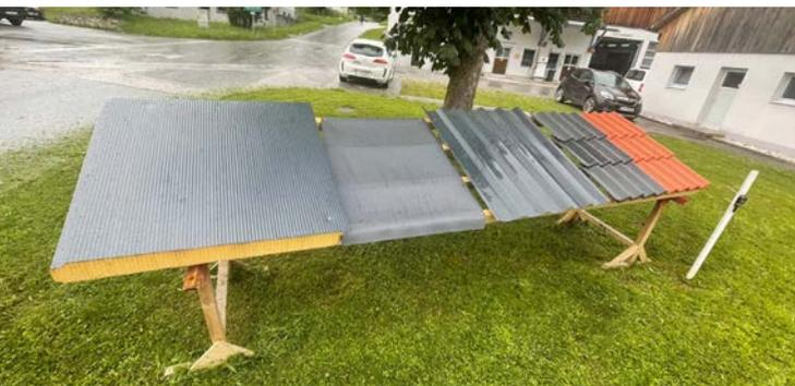
Abbildung 2: Unterschiedliche Dacheindeckungen im Test
